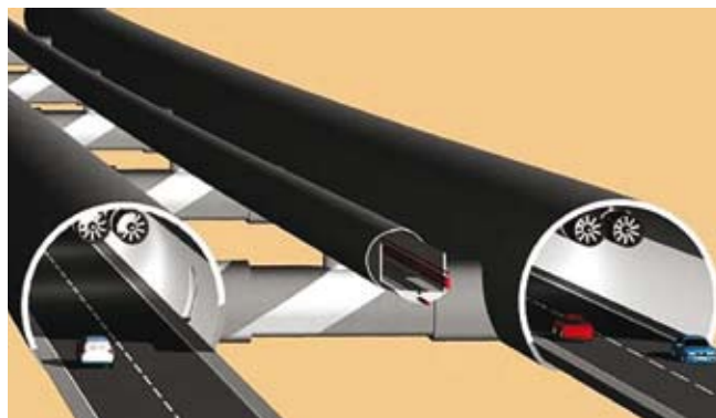
2. ábra: alagúthálózatba épített szellőztetőrendszerek [2]
