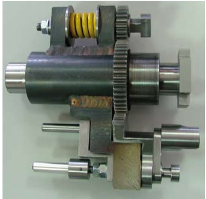
8. ábra: a mechatronikus aktuátor alapváltót működtető mechanizmusa
