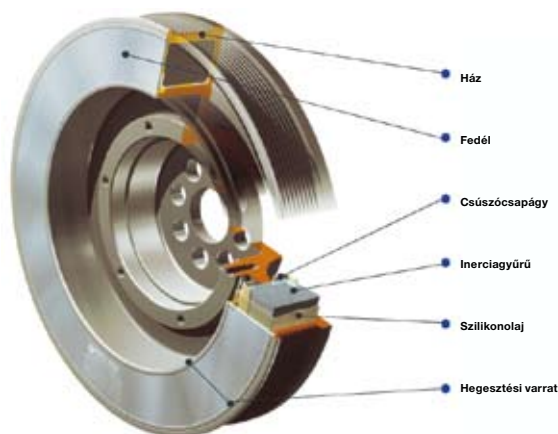
1. ábra: a viszkózus lengéscsillapító felépítése
