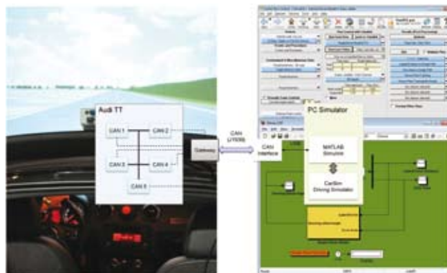
3. ábra: a járműszimulátor-rendszer blokkvázlata
