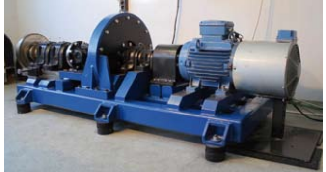
3. ábra: torziós lengéscsillapító-tesztapad
