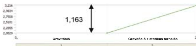
10. ábra: váz lehajlása átmetszett modell esetén
