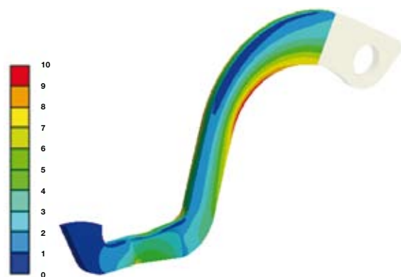
12. ábra: a pedálkar parametrikusan optimalizált modelljének egyenértékű feszültségeloszlása
