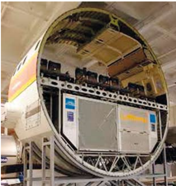
13. ábra: repülőgéptörzs metszete
