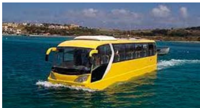
1. ábra: közúti és vízi közlekedésre alkalmas kételtű autóbusz
