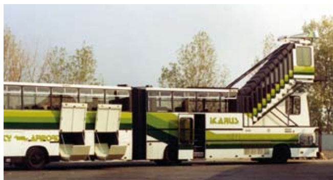
22. ábra: aszimmetrikus reptéri autóbusz
