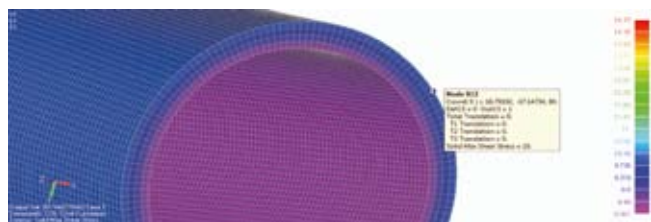
4. a ábra: csavaró ( \tau ) feszültség a cső felületén [MPa] (Forrás: saját szerkesztés)
