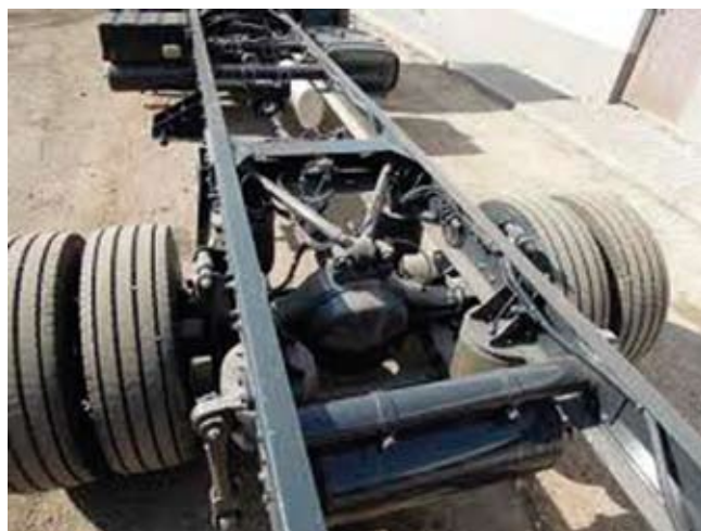
21. ábra: teherautó-alváz eltolt helyzetű keresztartókkal
