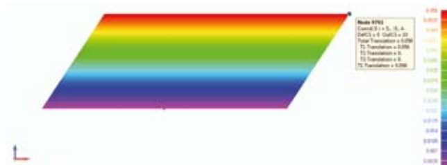
3. a ábra: a nyírásra igénybevett hasáb x-irányú (piros nyíl) elmozdulásai [mm] (Forrás: saját szerkesztés)
