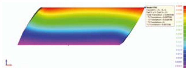
3. b ábra: a felső lapján, azzal párhuzamosan terhelte hasáb x-irányú (piros nyíl) elmozdulásai [mm] (Forrás: saját szerkesztés)
