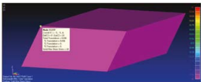
4. b ábra: nyíró ( \tau ) feszültség eloszlása a hasábon [MPa] (Forrás: saját szerkesztés)
