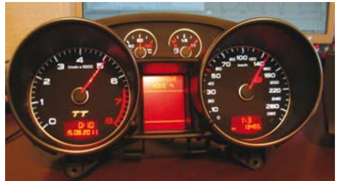
5. ábra: a műszerfal laboratóriumi RBS tesztje
