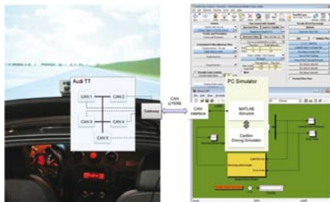
3. ábra: a járműszimulátor-rendszer blokkvázlata
