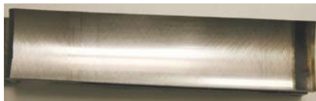
2. ábra: A kopott hengerfelületen a dugattyúgyűrűk alsó és felső holtpontjainak kopásnyomai
