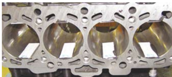
1. ábra: Szilikonlenyomat készítése a hengerfelületről
