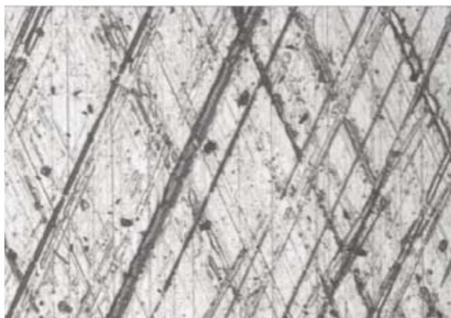
8-9. ábra: Az 1500 órát teljes terheléssel járatott motor kiindulási és kopott hengerfelületéről készített lenyomat képe
