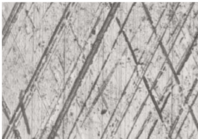
10-11-12. ábra: A spirálhónolt hengerfelület kiindulási, 40 és 140 órás kopott állapotáról készített lenyomat képe
